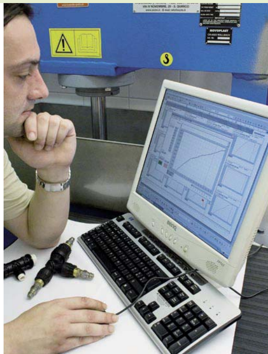
Druckprüfung von Bauteilen
